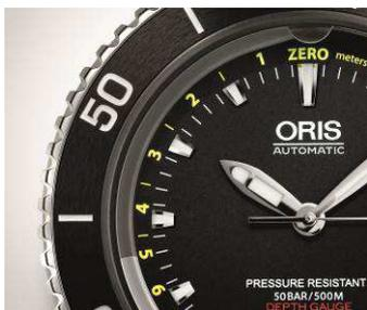
Un trou à 12 heures mène vers une cannelure sur la partie latérale de la glace. L'air à l'intérieur de la cannelure est comprimé, ce qui permet à l'eau de pénétrer dans cette cannelure. Le bord gris clair et gris foncé entre l'eau et l'air comprimé indique la profondeur lisible sur les graduations jaunes.
